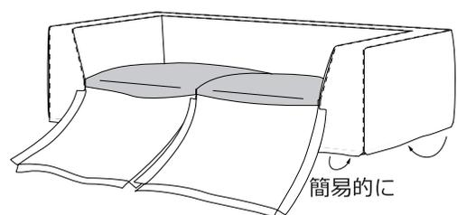
肘と背中、前側下部のトリコットテープを外し、マジックテープを本体側に貼り付けていきます。まず肘の内側前方から後方へ貼っていき、背内側、肘と背の外側という順に貼ります。この時点で肘と背中ではシワが無くなるようしっかりと貼り付けておきます。前側下部は簡易的に貼り付けます。
