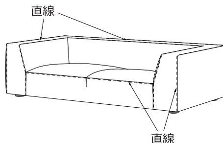
座カバーをセットする前に残りのトリコットテープを全て外し、後方に引っ張りながら後部、左右の順にマジックテープを貼り付けていきます。一度では綺麗に仕上がりません。後→右→後→左など何度か繰り返し、シワが出ないように貼り付けます。このとき前側下部のマジックテープも調整して貼り直します。
